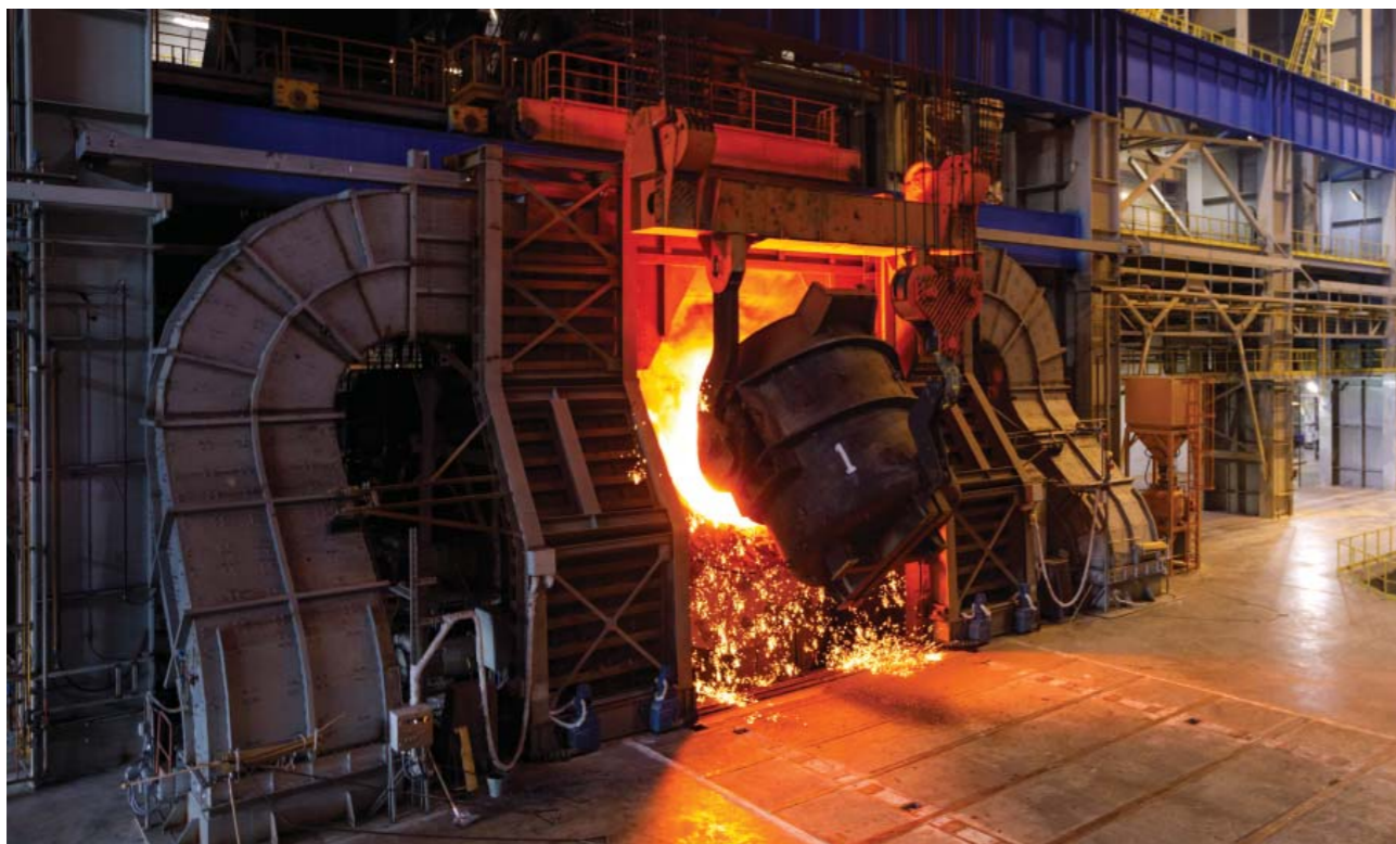
Заливка чугуна в конвертер
