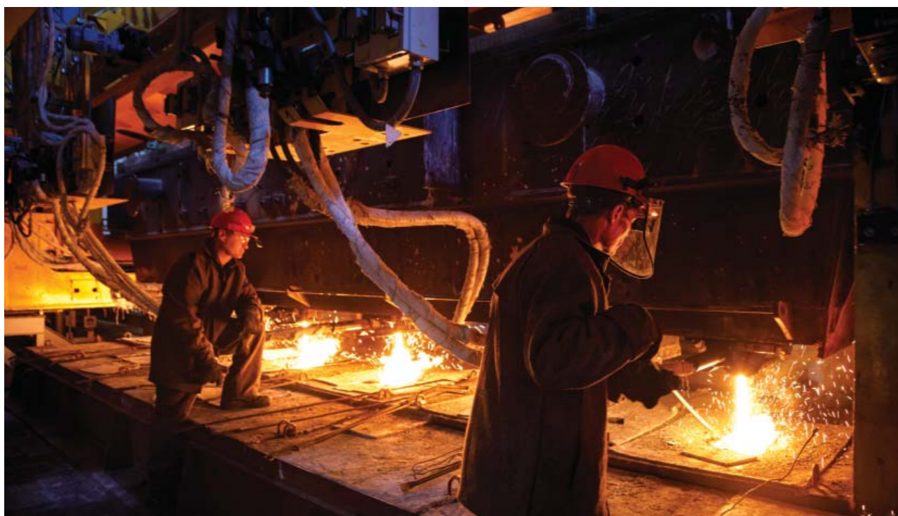
Разливка стали из промежуточного ковша в кристаллизаторы МНЛЗ
